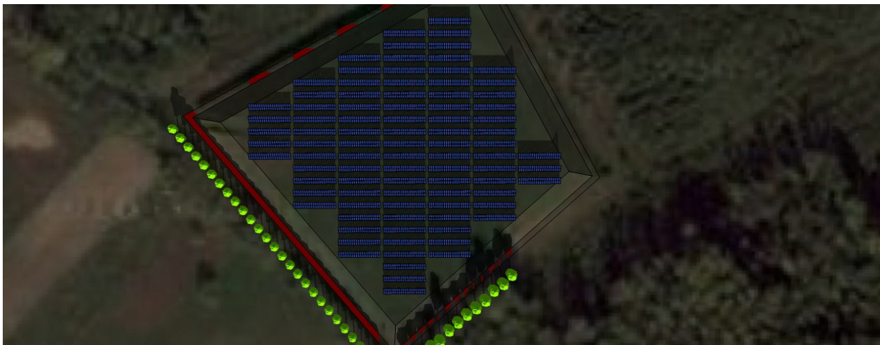
13. ábra: déli irányú telepítéssel 3640 db modul fér el. 265 W_p és 60 cellás modulokkal számolva ez 964 kW összteljesítmény lenne.
