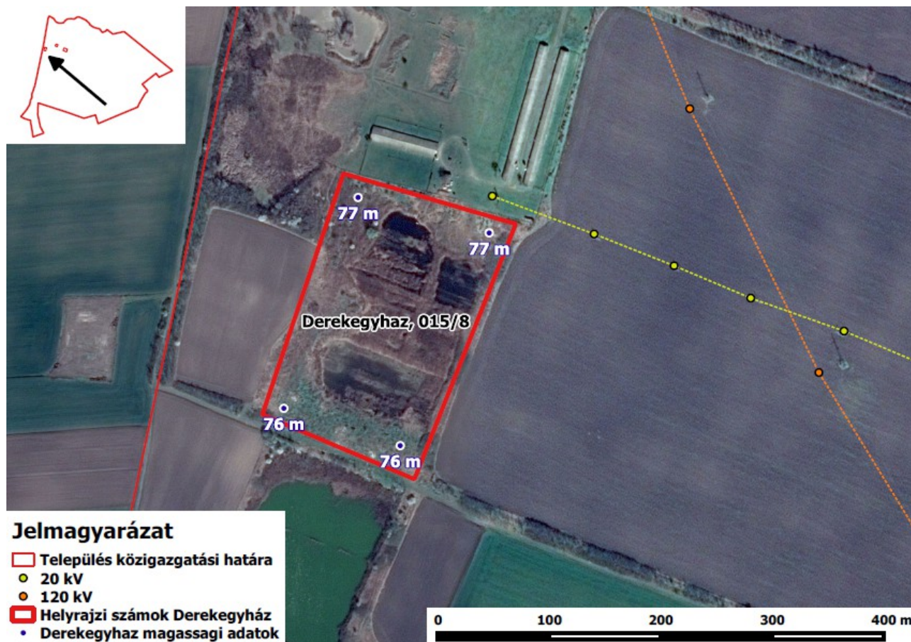
20. ábra: ez a terület több szempontból is megfelelhet naperőmű telepítésére: a 20 kV-os villamos betáplálása közel esik, és északról megoldott, azaz nem árnyékol. A 120 kV közelsége hosszú távon esetleg továbbfejleszthetővé teszi a PV energiaparkot. Továbbá méretéből adódóan is jól kihasználhatóak lennének a méretgazdaságossági előnyök.
